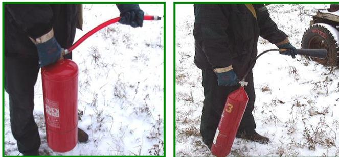
4. Подойти с наветренной стороны как можно ближе к горящему оборудованию или объекту. Направить раструб на очаг загорания и, нажав на рычаг пускового устройства, привести огнетушитель в действие
